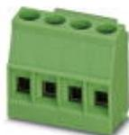
Terminal de p. placa de circuito impresso, corrente nominal: 24 A, tensão nominal: 400 V, passo: 5 mm, número de polos: 4, tipo de conexão: Conexão por rosqueamento com luva de tração, montagem: Solda por onda, sentido de conexão condutor/platina: 0 °, cor: verde. Produto com saída de pinos lateral
