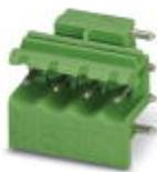
Header, corrente nominal: 12 A, tensão de teste (III/2): 320 V, número de polos: 4, passo: 5 mm, cor: verde, superfície de contato: Estanho, montagem: Solda, Produto com saída de pinos lateral
