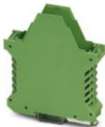
Caixa de montagem com fendas de ventilação, Parte inferior, conexão transversal: sem conector bus, cor: verde, largura: 22,5 mm, comprimento: 99 mm, altura: 107,3 mm, número de polos conector transversal: irrelevante
