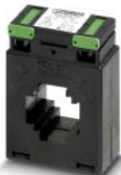
Transformador de corrente plugável, corrente primária 100 A AC; corrente secundária 5 A AC; classe de precisão 1; potência nominal 2,5 VA
