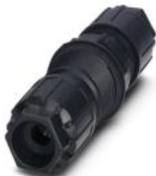
Passagem de parede do conector de cabo em ambos os lados com porca QPD, cinza, 4 polos, 1,0 mm<sup>2</sup> ... 2,5 mm<sup>2</sup>/ 630 V / 20 A, para diâmetros de cabo de 9 mm ... 14 mm.
