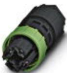
Conector, Conexão QUICKON, Número de pólos: 3+PE, 1 mm<sup>2</sup> ... 2,5 mm<sup>2</sup>, 690 V, 20 A, preto, Diâmetro de cabo: 6 mm ... 10 mm
