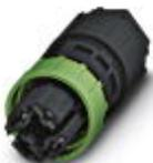
Conector, Conexão QUICKON, Número de pólos: 3+PE, 1 mm<sup>2</sup> ... 2,5 mm<sup>2</sup>, 690 V, 20 A, preto, Diâmetro de cabo: 9 mm ... 14 mm
