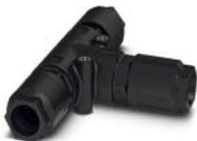
Distribuidor T, Conexão QUICKON, Número de pólos: 4+PE, 2,5 mm<sup>2</sup> ... 6 mm<sup>2</sup>, 690 V, 40 A, preto, com três porcas QUICKON, Diâmetro de cabo: 9 mm ... 14 mm
