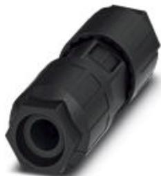
Conector de cabo QUICKON, preto, 4+PE polos, 2,5 mm<sup>2</sup> ... 6,0 mm<sup>2</sup>/690 V/40 A, para diâmetro de cabo 12 mm ... 20 mm.
