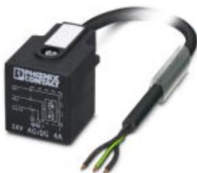
Cabo sensor/atuador, 3-pólos, PUR livre de halogênio, preto acinzentado RAL 7021, extremidade livre do condutor, para Conector de válvula A, com 1 LED, ligado com Diodo Z, Comprimento de cabo: 5 m
