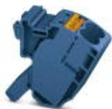
Borne para detector, tipo de conexão: Conexão Push-in, quantidade de conexões: 2, perfil de conexão: 0,5 mm<sup>2</sup> - 16 mm<sup>2</sup>, AWG: 20 - 6, largura: 18,5 mm, altura: 34,7 mm, cor: azul, tipo de montagem: na base
