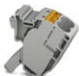
Borne para detector, tipo de conexão: Conexão Push-in, quantidade de conexões: 2, perfil de conexão: 0,5 mm<sup>2</sup> - 16 mm<sup>2</sup>, AWG: 20 - 6, largura: 18,5 mm, altura: 34,7 mm, cor: cinza, tipo de montagem: na base
