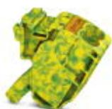
Borne para detector, tipo de conexão: Conexão Push-in, quantidade de conexões: 2, perfil de conexão: 0,5 mm<sup>2</sup> - 16 mm<sup>2</sup>, AWG: 20 - 6, largura: 18,5 mm, altura: 34,7 mm, cor: verde/amarelo, tipo de montagem: na base
