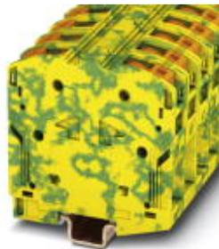
Borne terra modular, tipo de conexão: Conexão Power-Turn, quantidade de conexões: 2, perfil de conexão: 25 mm<sup>2</sup> - 95 mm<sup>2</sup>, AWG: 4 - 3/0, largura: 25 mm, cor: verde-amarelo, tipo de montagem: Trilho de fixação de cobre de 2,3 mm
