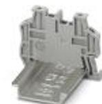
Suporte terminal para montagem rápida, para trilho de fixação NS 35/7,5 ou trilho de fixação NS 35/15, com possibilidade de marcação, com possibilidade de fixação para FBS...5, FBS...6, KSS 5, KSS 6, largura: 5,15 mm, cor: cinza
