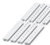
Tira Zack, Fitas, branco, não impresso, identificável com: CMS-P1-PLOTTER, PLOTMARK, Tipo de montagem: Travamento em ranhura elevada de plaqueta, para a largura de terminal: 8,2 mm, Tamanho para gravação: 10,5 x 8,15 mm
