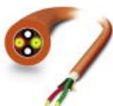
Cabo de instalação GOF montável e robusto (apenas cabeças IP20), para disposição interior com elementos de alívio de tensão de aramida de elevada resistência. Elementos individuais fabricados a partir de material FRNC altamente flexível. Sem halogênio, resistente à exposição ao ozono e UV com revestimento exterior robusto em poliuretano (PUR).
