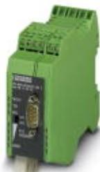
Conversor de fibra óptica com diagnóstico óptico integrado, contato de alarme, para interfaces RS-232 até 115,2 Mbit/s, dispositivo terminal com uma interface de fibra óptica (SC-duplex), 1300 nm, para cabo de fibra de vidro
