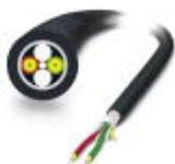
Cabo redondo GOF, para montar, altamente robusto (apenas para cabeças IP20) para colocação externa com barreira de vapor integrada e camada de fio de vidro à prova de roedores. Elementos individuais de material FRNC altamente flexível. Resistente à exposição ao ozono e UV, com revestimento exterior em polietileno altamente robusto.
