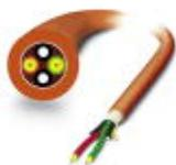
Cabo de instalação GOF montável e robusto, para disposição interior com elementos de alívio de tensão de aramida de elevada resistência. Elementos individuais fabricados a partir de material FRNC altamente flexível. Sem halogênio, resistente à exposição ao ozono e UV com revestimento exterior robusto em poliuretano (PUR).
