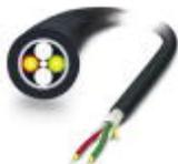
Cabo redondo PCF montável e altamente robusto (apenas para cabeças IP20) para colocação externa com barreira de vapor integrada e camada de fio de vidro à prova de roedores. Elementos individuais de material FRNC altamente flexível. Resistente à exposição ao ozônio e UV, com revestimento exterior altamente robusto em polietileno.
