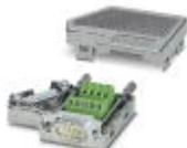
Conector D-SUB, 9 polos, pino, duas entradas de cabos inferiores a 35°, tipo universal para todos os sistemas, configuração de pinos: 1, 2, 3, 4, 5, 6, 7, 8, 9 sobre um terminal de conexão por rosqueamento cada
