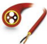
Cabo de instalação POF montável e robusto, (apenas para cabeças IP20) para disposição fixa no interior. Elementos individuais fabricados de poliamida (PE) altamente resistente. Sem halogênio, resistente à exposição ao ozônio e UV com revestimento exterior em poliuretano reforçado (PUR).
