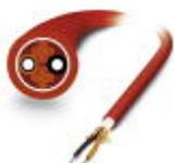
Cabo redondo POF montável e altamente flexível (apenas cabeças IP20), para aplicação em correia de arraste. Elementos individuais fabricados de poliamida (PE) altamente resistente. Sem halogênio, resistente à exposição ao ozônio e UV com revestimento exterior robusto em poliuretano (PUR).
