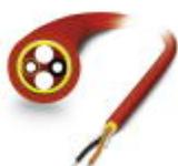
Cabo de instalação POF montável e robusto, para disposição fixa no interior. Concebido para elevados requisitos em termos de tração e compressão lateral, com elementos individuais fabricados a partir de poliamida (PE) altamente resistente. Sem halogênio, resistente à exposição ao ozônio e UV com revestimento exterior em poliuretano reforçado (PUR).
