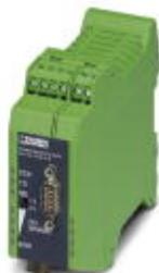
Conversor de fibra óptica com diagnóstico óptico integrado, contato de alarme, para interfaces RS-232 até 115,2 kBit/s, equipamento final com uma interface de fibra óptica (FSMA), 660 nm, para cabo de fibra polimérica/PCF
