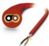
Cabo de instalação POF montável (apenas para cabeças IP20) para disposição fixa no interior com elementos individuais fabricados com poliamida (PE) de alta resistência. Sem halogênio, resistente à exposição ao ozono e UV com revestimento exterior robusto em poliuretano (PUR).
