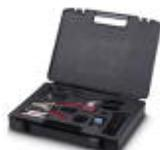
Caixa de montagem PCF para conectores de montagem rápida F-SMA, inclui lâmina de decapagem, alicate de decapagem, tesoura para fio de aramida, descascador de fibras, microscópio, ferramenta de corte para fibras PCF padrão, quatro conectores F-SMA para fibras PCF padrão e documentação
