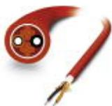
Cabo redondo POF montável e altamente flexível, para aplicação em correia de arraste para uma frequência de torção alternada máx. de 5 mil milhões de ciclos com elementos individuais fabricados de poliamida (PE) altamente resistente. Sem halogênio, resistente à exposição ao ozono e UV com revestimento exterior robusto em poliuretano (PUR).
