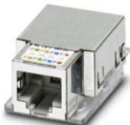
Elemento de soquete RJ45, Grau de proteção: IP20, Número de pólos: 8, CAT5 (IEC 11801:2002), Material: Liga de cobre, Tipo de conexão: IDC, Perfil de conexão: AWG 24-22
