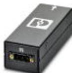
O PC-PWR-FLTR-2 armazena a energia entrante até que a tensão operacional seja alcançada. Para a operação com fontes de tensão de 24 V DC com tempos de subida de mais de 100 ms e, no máximo, 7 A.
