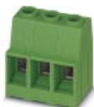
Terminal de p. placa de circuito impresso, Corrente nominal: 76 A, Tensão nominal: 1000 V, Medida do passo: 10,16 mm, Número de pólos: 3, Tipo de conexão: Conexão por rosqueamento com luva de tração, Montagem: Solda por onda, Sentido de conexão Condutor/platina: 0 °, Cor: verde, O produto pode ser alinhado com diversos números de polos!
