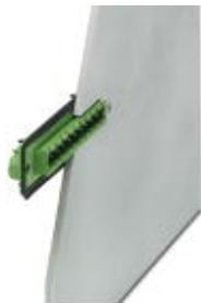
Header, Corrente nominal: 12 A, Tensão de dimensionamento (III/2): 320 V, Número de pólos: 10, Medida do passo: 5,08 mm, Cor: verde, Superfície de contato: Estanho, Montagem: Solda por onda
