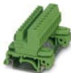
Plugue conector, Corrente nominal: 12 A, Tensão de dimensionamento (III/2): 320 V, Número de pólos: 10, Medida do passo: 5,08 mm, Tipo de conexão: Conexão por rosqueamento com luva de tração, Cor: verde, Superfície de contato: Estanho, Montagem: Trilho de fixação
