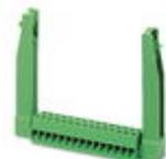
Plugue conector, Corrente nominal: 12 A, Tensão de dimensionamento (III/2): 320 V, Número de pólos: 10, Medida do passo: 5,08 mm, Tipo de conexão: Conexão por rosqueamento com luva de tração, Cor: verde, Superfície de contato: Estanho, Montagem: Montagem direta
