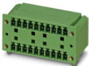
Header, Corrente nominal: 8 A, Tensão de dimensionamento (III/2): 160 V, Número de pólos: 10, Medida do passo: 3,81 mm, Cor: verde, Superfície de contato: Estanho, Montagem: Solda por onda, Na combinação com partes do conector MCV se deve usar respectivamente um conector MCVW e um MCVR.
