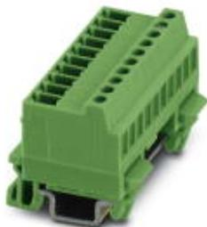
Plugue conector, Corrente nominal: 8 A, Tensão de dimensionamento (III/2): 160 V, Número de pólos: 10, Medida do passo: 3,81 mm, Tipo de conexão: Conexão por rosqueamento com luva de tração, Cor: verde, Superfície de contato: Estanho, Montagem: Trilho de fixação
