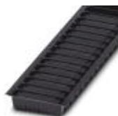
Header, Corrente nominal: 8 A, Tensão de dimensionamento (III/2): 160 V, Número de pólos: 5, Medida do passo: 3,81 mm, Cor: preto, Superfície de contato: Estanho, Montagem: THR solda, As informações para o usuário e recomendações de especificação sobre a tecnologia Through Hole Reflow encontram-se em "Downloads"
