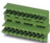
Header, Corrente nominal: 10 A, Tensão de dimensionamento (III/2): 320 V, Número de pólos: 6, Medida do passo: 5 mm, Cor: verde, Superfície de contato: Estanho, Montagem: Solda por onda, O produto pode ser alinhado com diversos números de polos! Na combinação com partes do conector MVSTB ou FKCV se deve usar um conector MVSTBW (ou FKCVW) e um MVSTBR (ou FKCVR). Não é possível a combinação com as partes do condutor TMSTBP!
