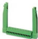
Plugue conector, Corrente nominal: 12 A, Tensão de dimensionamento (III/2): 320 V, Número de pólos: 2, Medida do passo: 5,08 mm, Tipo de conexão: Conexão por rosqueamento com luva de tração, Cor: verde, Superfície de contato: Estanho, Montagem: Montagem direta
