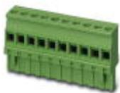
Plugue conector, Corrente nominal: 12 A, Tensão de dimensionamento (III/2): 320 V, Número de pólos: 2, Medida do passo: 5,08 mm, Tipo de conexão: Conexão por rosqueamento com luva de tração, Cor: verde, Superfície de contato: Estanho
