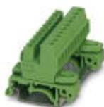
Plugue conector, Corrente nominal: 12 A, Tensão de dimensionamento (III/2): 320 V, Número de pólos: 7, Medida do passo: 5,08 mm, Tipo de conexão: Conexão por rosqueamento com luva de tração, Cor: verde, Superfície de contato: Estanho, Montagem: Trilho de fixação
