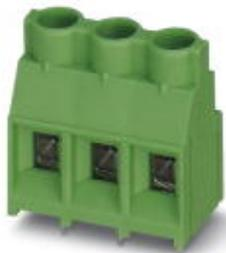
Terminal de p. placa de circuito impresso, Corrente nominal: 32 A, Tensão nominal: 630 V, Medida do passo: 7,62 mm, Número de pólos: 3, Tipo de conexão: Conexão por rosqueamento com luva de tração, Montagem: Solda por onda, Sentido de conexão Condutor/platina: 0 °, Cor: verde, O produto pode ser alinhado com diversos números de polos!
