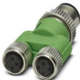
Distribuidor Y, 4-pólos, Conector reto M12 SPEEDCON, codificação A, para Soquete reto M8, codificação A e Soquete reto M8, codificação A
