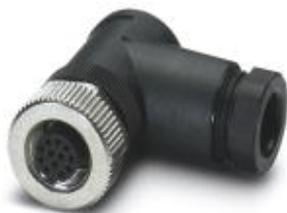
Conector, Universal, 12-pólos, Soquete angular M12, codificação A, Conexão soldável, Material serrilhado: Fundição de zinco sob pressão, niquelado, Prensa-cabos Pg9, Diâmetro externo do cabo 6 mm ... 8 mm
