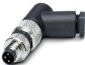
Conector, 3-pólos, Conector angular M8, codificação A, Conexão a parafuso, Material serrilhado: Latão, níquelado, Diâmetro externo do cabo 3,5 mm ... 5 mm
