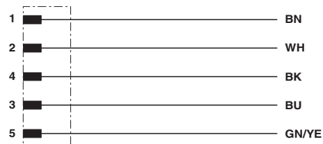
Esquema de ligação do conector M12
