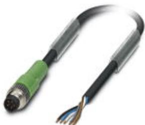
Cabo sensor/atuador, 5-pólos, PUR, preto acinzentado RAL 7021, Conector reto M8, Codificação B, para extremidade livre do condutor, Comprimento de cabo: 5 m
