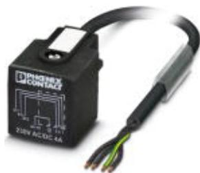
Cabo sensor/atuador, 4-pólos, PUR livre de halogênio, preto acinzentado RAL 7021, extremidade livre do condutor, para Conector de válvula AD (pressostato), Comprimento de cabo: 3 m
