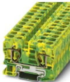
Borne terra modular, Tipo de conexão: conexão à mola, Bitola: 0,2 mm<sup>2</sup> - 16 mm<sup>2</sup>, AWG: 24 - 6, Largura: 10,2 mm, Cor: verde-amarelo, Tipo de montagem: NS 35/7,5, NS 35/15
