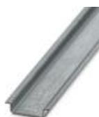
Trilho de fixação com perfil em U, material: galvanizado, não perfurado, altura 7,5 mm, largura 35 mm, comprimento: 2 m
