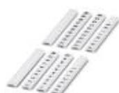
Tira Zack plana, Fitas, branco, identificado, impresso horizontalmente: números ímpares 1-19, 21-39, etc. até 81-99, Tipo de montagem: Travamento em ranhura plana de plaqueta, para a largura de terminal: 5 mm, Tamanho para gravação: 5,15 x 5,15 mm
