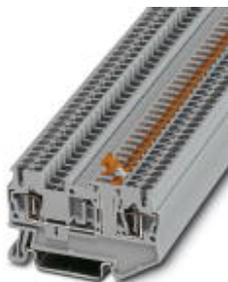
Borne de separação por lâmina, Tipo de conexão: conexão à mola, Bitola: 0,08 mm<sup>2</sup> - 4 mm<sup>2</sup>, AWG: 28 - 12, Corrente nominal: 20 A, Tensão nominal: 400 V, Comprimento: 60,5 mm, Largura: 5,2 mm, Cor: cinza, Montagem: NS 35/7,5, NS 35/15
