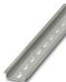
Trilho de fixação, material: aço galvanizado e bicromatizado, perfurado, altura 7,5 mm, largura 35 mm, comprimento: 2000 mm
