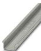
Trilho de fixação com perfil em U, material: aço, não perfurado, 2,3 mm de espessura, altura 15 mm, largura 35 mm, comprimento: 2 m
